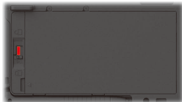
Falsch (roter Teil sichtbar)
