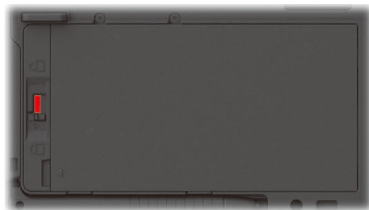
Falsch (roter Teil sichtbar)
