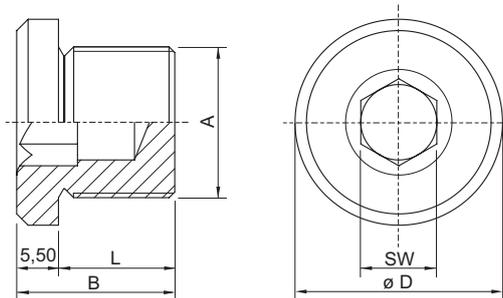
A = Gewindegröße B = Länge L = Gewindelänge
