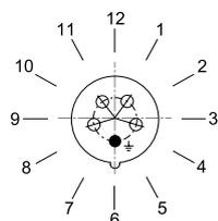
Disposition des fiches de contact et repérage des bornes
