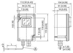
8146/5041-... Contrôleur et limiteur de température de sécurité Appareil individuel
