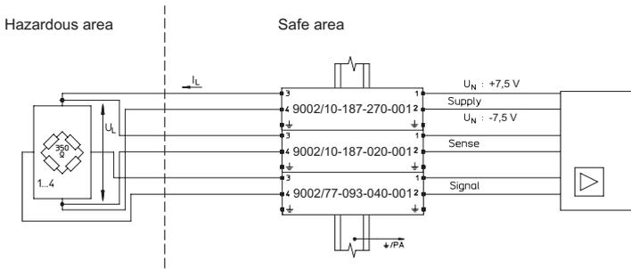
Caso de aplicación: célula de carga (DMS) 350 Ω o 700 Ω
