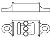
Adecuado para raíles de montaje DIN NS35/15, permite montar el raíl aislado eléctricamente de la placa de montaje.
