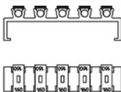
El portafusibles se engancha con clips en el lateral de una barrera de seguridad intrínseca y puede equiparse con hasta 5 fusibles previos (repuesto).
