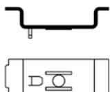
El adaptador permite montar una barrera de seguridad intrínseca de la serie 900x en una placa de montaje de una serie anterior.
